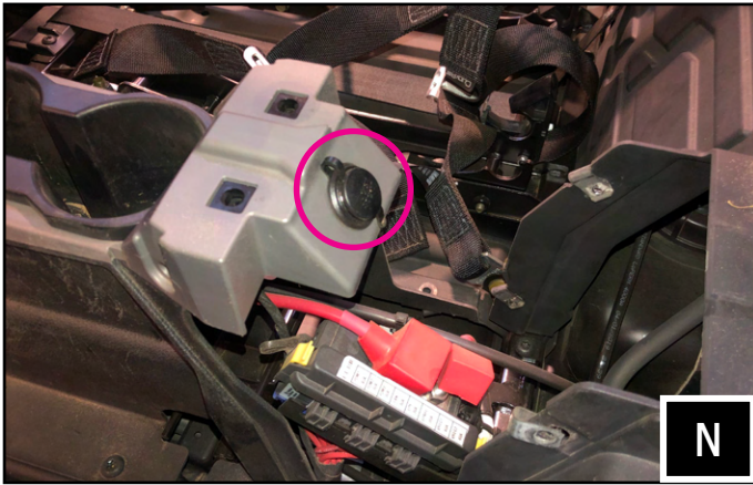
N. Disconnect the 12V socket.
